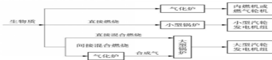
图4-31 生物质发电的主要方式
