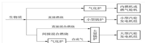
[图片]图4-31 生物质发电的主要方式
